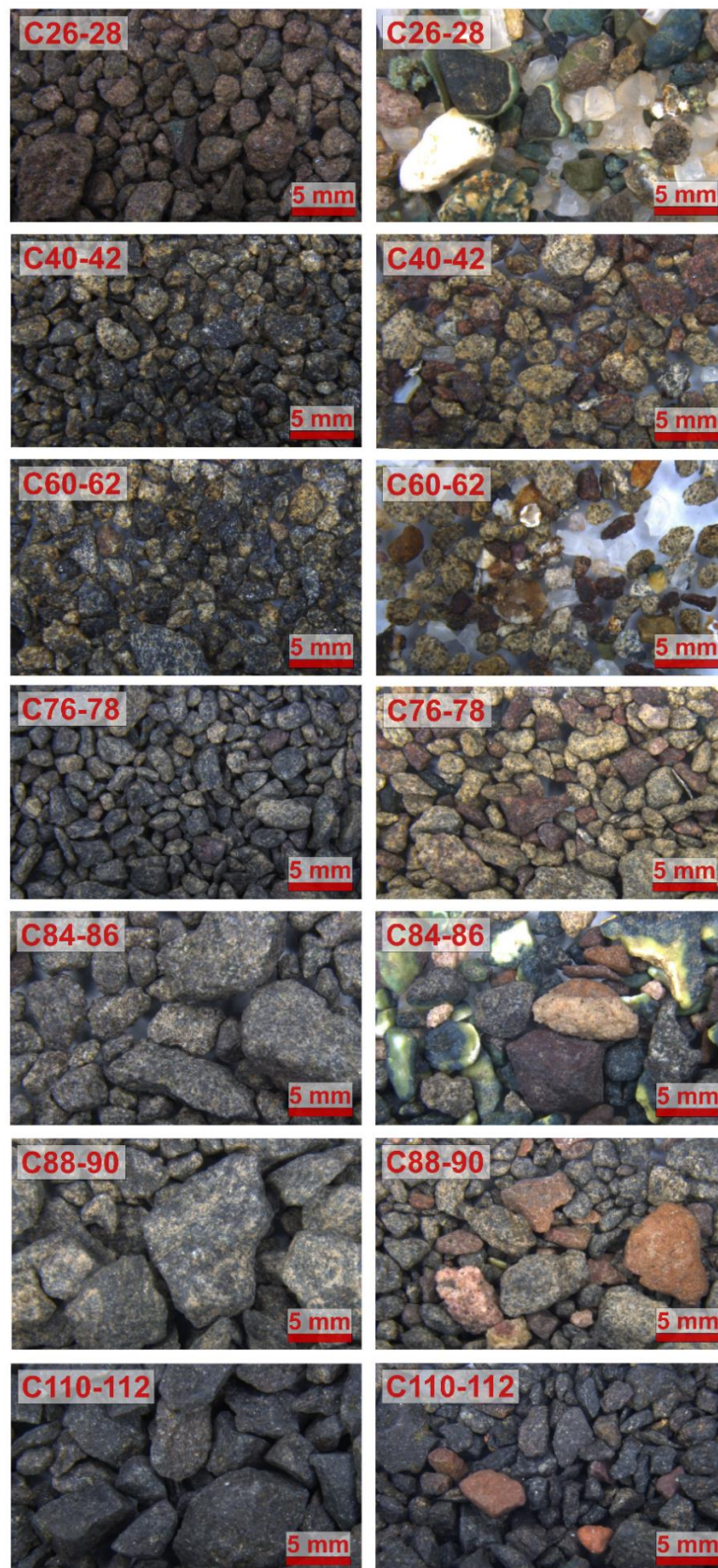
Figura 5: Fotos obtidas por lupa das amostras do poço tubular D-5 selecionadas para análise química (apenas dos grãos retidos na peneira de abertura 0,59 mm). À esquerda, os grãos menos alterados e mais homogêneos, selecionados para serem analisados. À direita, os restos de cada amostra, retirados utilizando lupa e pinça, que incluem minerais secundários (calcita, agregados de argilominerais esverdeados, quartzo e zeólitas) e grãos muito alterados.
